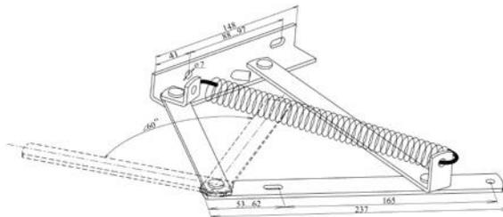
Спектр применения данной группы механизмов довольно-таки широк, они применяются для подъема спального места (или сиденья) и дают возможность доступа к бельевому ящику (или коробу). Конструкция механизмов дает возможность поднятия блока со смещением (в отличии от обычной петли), в результате предотвращает заклинивание матраса.
