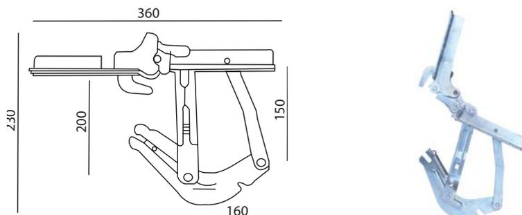
Относится к группе «клик-кляк», имеет дополнительный угол раскладки спинки – «релакс». Конструкцией предусмотрено крепление механизма внутри короба, что дает возможность не использовать в диване боковины. Защелка механизма дополнительно подпружинена. Также дополнительные пружины установлены и на направляющих (это сделано для более легкой и плавной раскладки). Благодаря длине направляющих, имеет большой относ спинки от стены.
