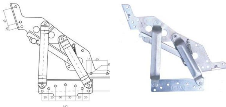
Данный механизм давно заслужил славу «безотказного» благодаря хорошо проработанной системе фиксации (рычаг защелки дополнительно подпружинен и сама защелка находится в П-образном профиле, защищена от заклинивания). Направляющие имеют ребра жесткости, а крепежные пластины загиб для более качественной фиксации рамок дивана.
